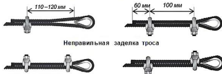
Рисунок 6 – Заделка троса
